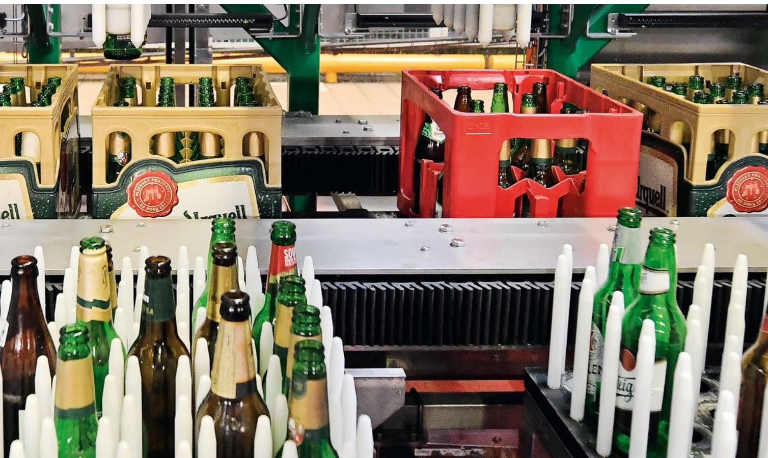
Pokročilé technológie umožňujú kontrolu v každej fáze procesu stáčania. Patrí sem napríklad automatické triedenie vratných fliaš, kontrola prázdnych fliaš po umytí, kontrola hladiny a uzáveru po naplnení a dôkladná kontrola po pasterizácii vrátane revízie etikiet a čitateľnosti údajov. Linku riadi inteligentný systém Line Management, ktorý optimalizuje prevádzku linky, minimalizuje straty materiálu a energie a je prepojený s logistickými a plánovacími systémami.
